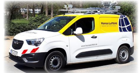
Es werden Bilder vom gesamten Verkehrsraum erstellt. Dann wird auf dieser Bildgrundlage eine vollständige Bestandsdatenerfassung durchgeführt. Während der Befahrung werden entlang von Straßen hochauflösende und georeferenzierte Bildsequenzen erstellt. Die dabei erfassten Daten sind notwendig, um die Planungsarbeiten für die Glasfaser-Internetoffensive der Gemeinde zu finalisieren.
